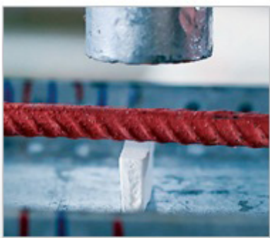
Figura 3 - Detalhe do posicionamento da peça de gesso em relação à armadura
