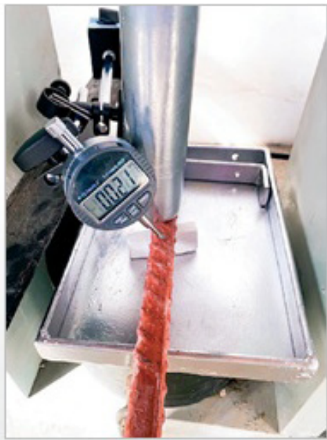
Figura 2 - Detalhe da prensa com extensômetro
