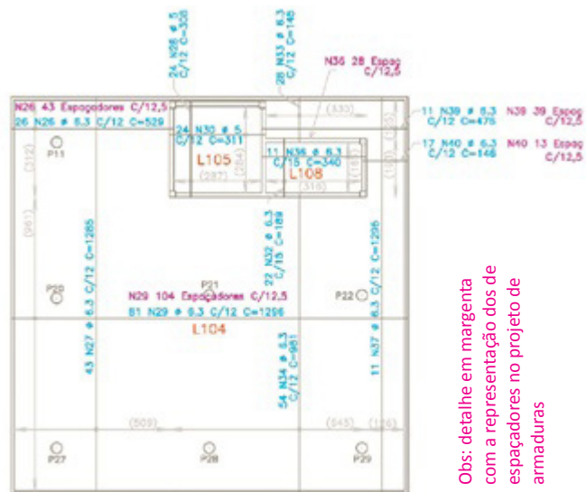
Figura 6 - Projeto de armadura de laje
