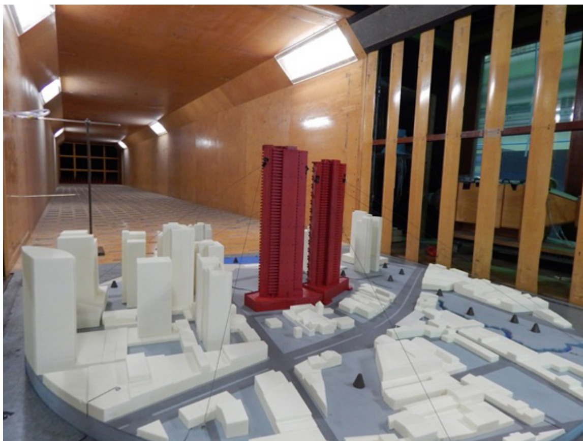
Figura 2.3.1.1 – Ensaio em túnel de vento do Edifício One e Edifício Sky
